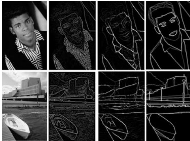
Рис. 2. Изображение, модули градиентов его яркости и выделенные контуры
