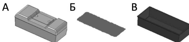
Рис.1 – схема строения LVT. А – бетонный блок, Б – эластичная прокладка, В – резиновый чехол.
