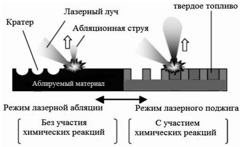
Рис.3. Режим лазерной абляции и режим лазерного поджига
